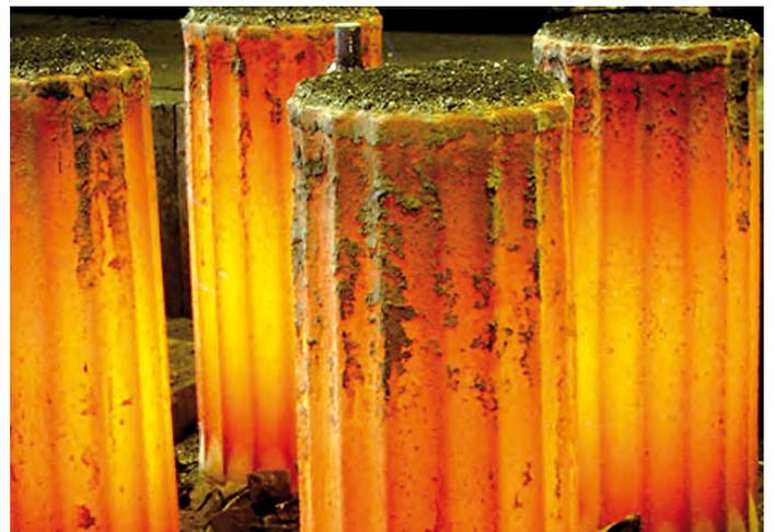
Blockguss aus dem Stahlwerk Bous.
